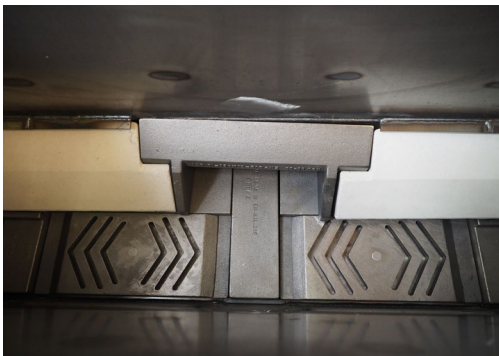
Brennraum mit 60 oder 110 cm Breite und einfach auswechselbaren Komponenten.
