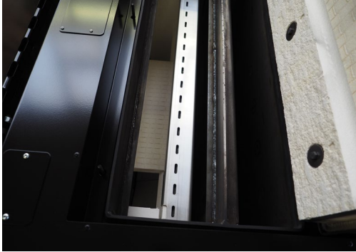
Hochtemperaturkammer für Temperaturen von +/- 1000 °C
